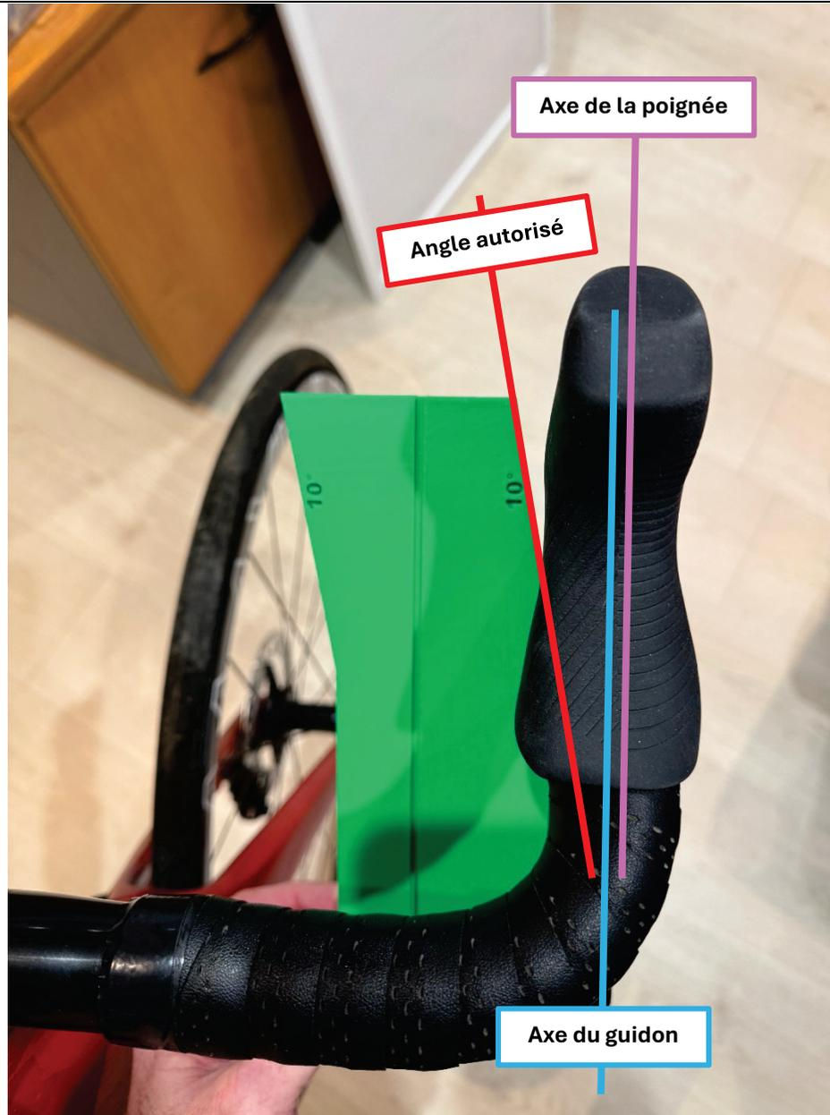
L'angle entre l'axe de la poignée et l'axe du guidon est inférieur à 10°
