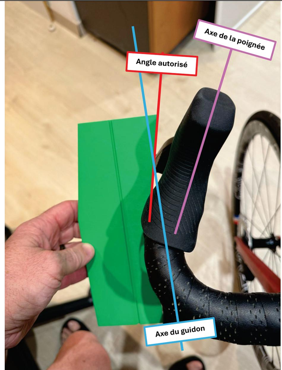
L'angle entre l'axe de la poignée et l'axe du guidon est supérieur à 10°
