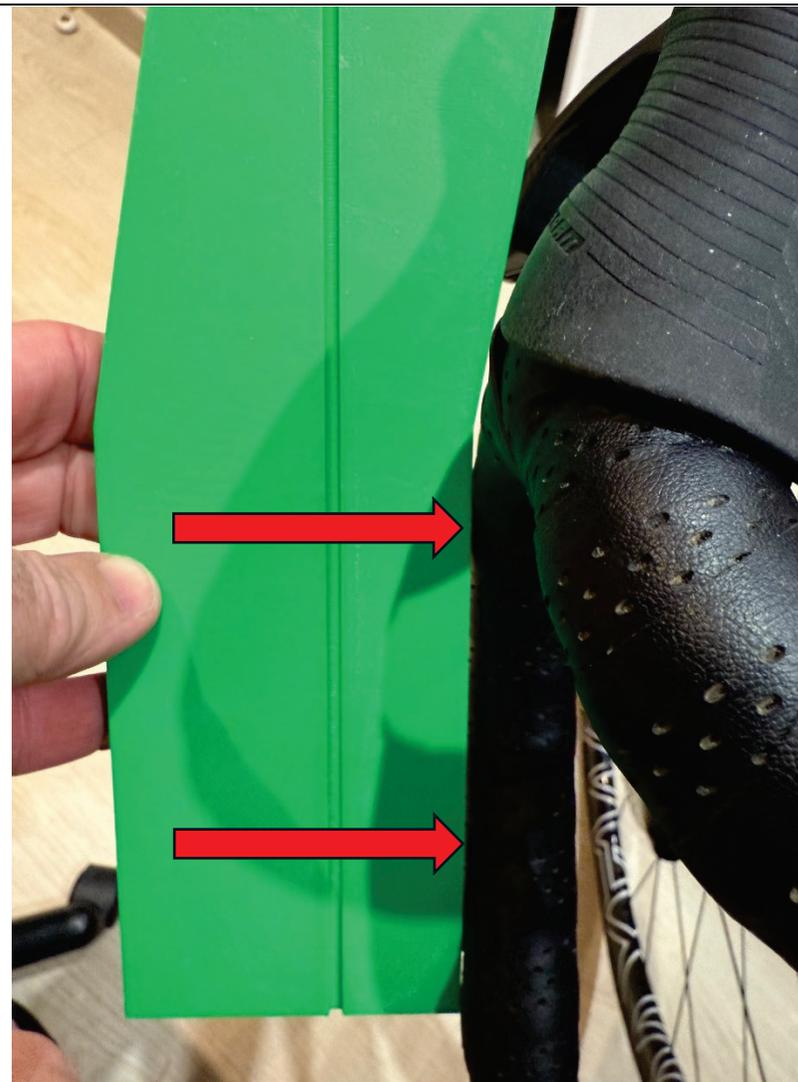
Il est important d'avoir **2 points** de contact entre la partie droite du gabarit et le guidon.
